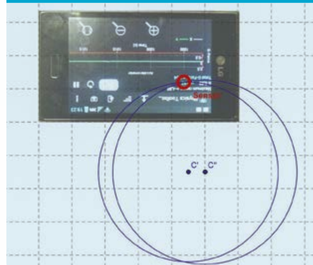
ABB.5 Die Drehzentren C' und C'' sind die Referenzpunkte für die beiden Positionen des Smartphones auf dem Plattenspieler
